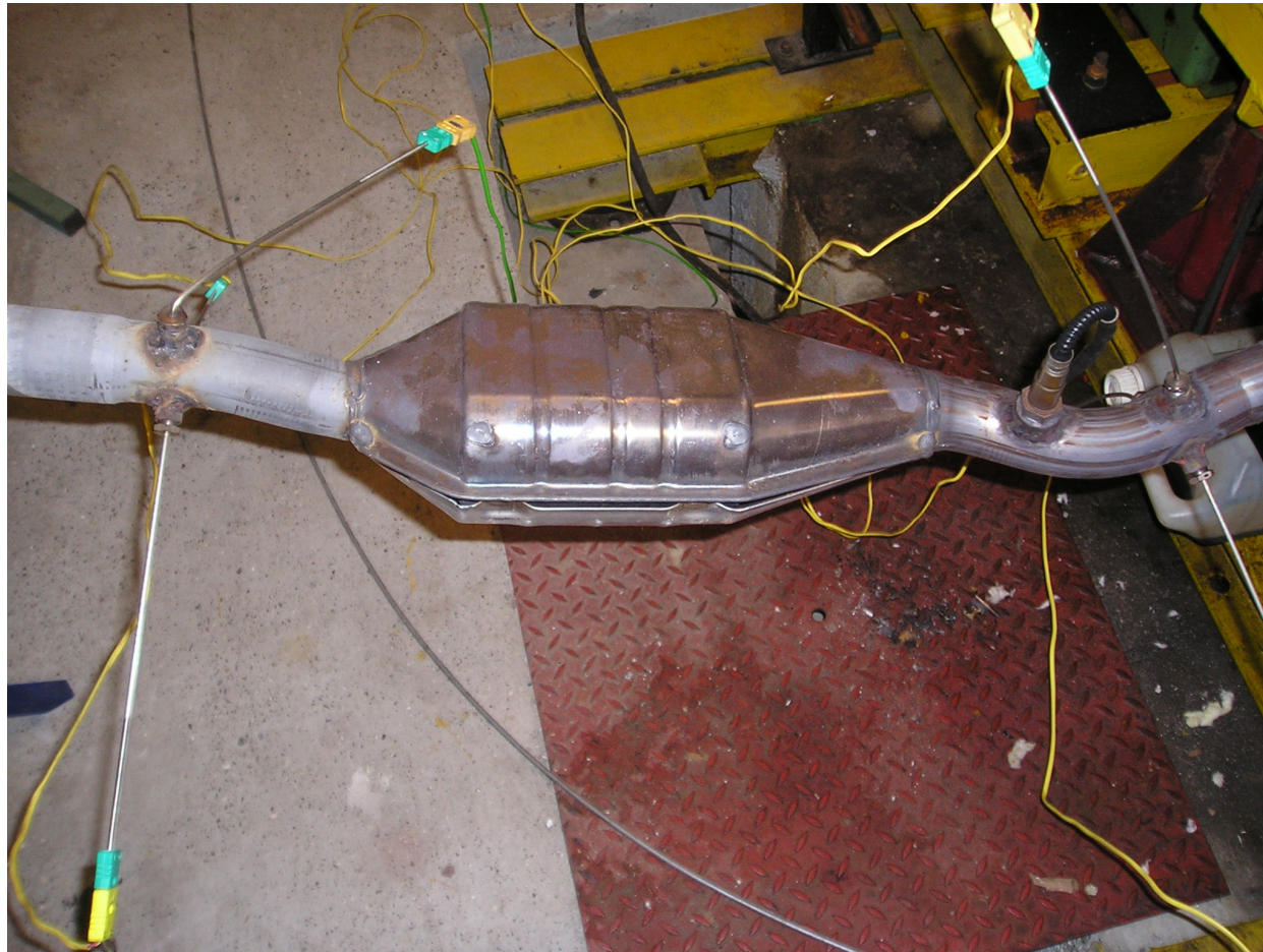
Fig 3 : adaptation d'un catalyseur et disposition des thermocouples
