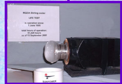
Sunpower durée de vie M223 cooler- 51,429 heures le 15 September 2001.
