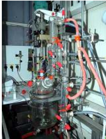
Réacteur batch labo 1L-10L
