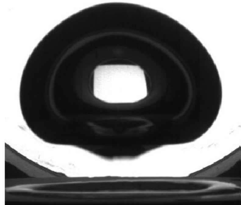
Grosse bulle isolée Forme sphéroïde aplatie Long temps d'attente
