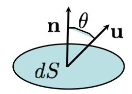
Flux de chaleur à travers  $d\Phi = I_{\omega}(\mathbf{r}, \mathbf{u}) \cos \theta dS d\Omega$  une surface
