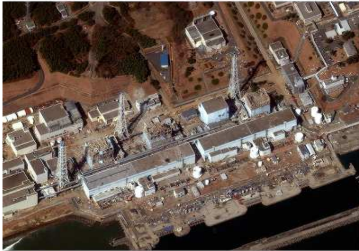
Etat de la centrale nucléaire de Fukushima Daichi le 18 mars 2011 : trois réacteur sont éventrés. © DigitalGlobe
