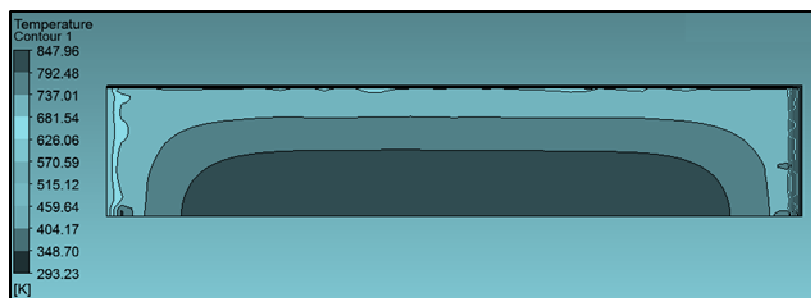
A – Contours des températures moyennes d'adsorption à 2.0e+3 secondes avec la méthode C-V 3D et les instabilités engendrées par P_{eq}
