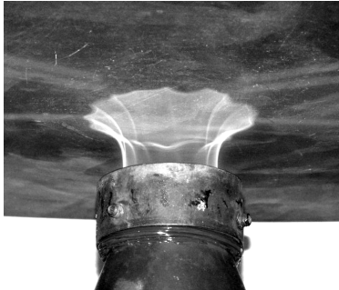
Figure 7 : Impact de la flamme sur l'échantillon – Cas H/D=1.3
