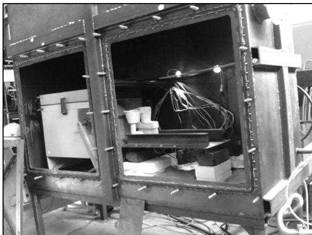
Figure 1 : dispositif expérimental : enceinte avec le four à creuset inclinable (à gauche, premier plan).
