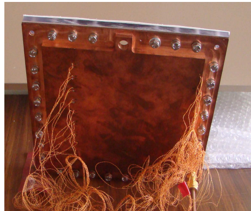
Figure 2d: Vue arrière de la section d'essai avec les micro thermocouples.
