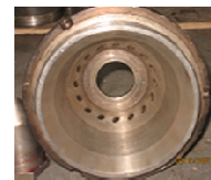
Figure 3. Vue interne du turbulateur d'air de combustion
