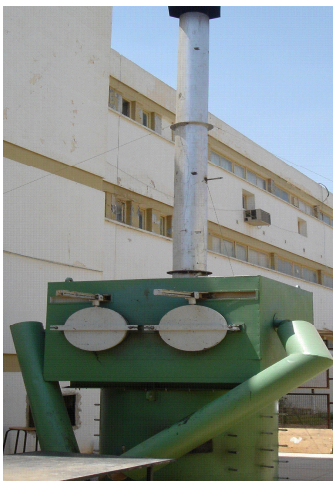
Figure 1 Unité pilote de carbonization de bois
