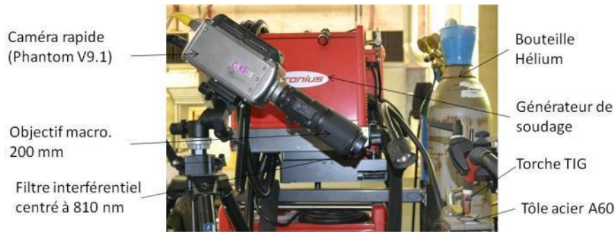
Figure 1 : Photographie du dispositif expérimental : à gauche, la caméra Phantom équipée de l'objectif de 200 mm de focale, à droite, la torche TIG.
