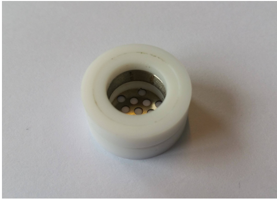
Figure 3 Support d'un couple d'électrodes, anneau : électrode de masse, grille : électrode de haut potentiel
