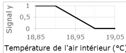
Figure 4 : Signal contrôlant les composants d'appoints de chauffage
