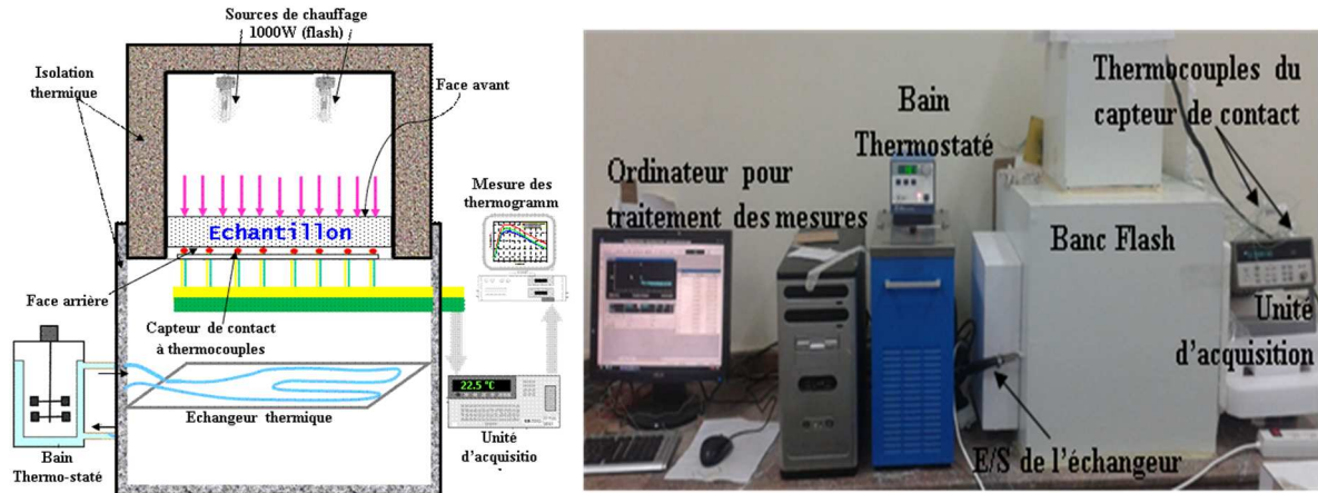
Figure 3 : Le dispositif expérimental mis en place pour l'analyse thermique locale
