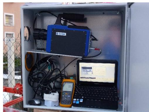
Figure 12 : Intérieur du caisson étanche avec caméra thermique
