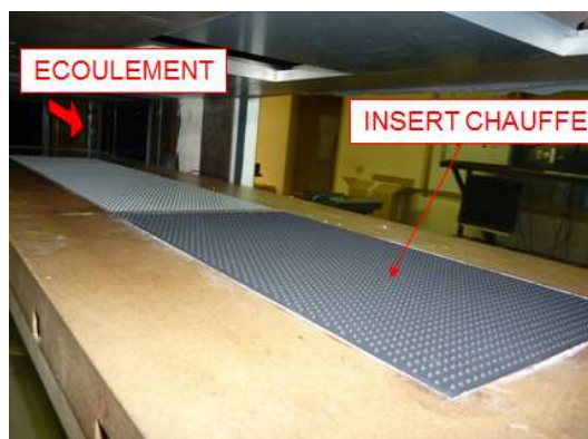
Figure 1 : Maquette n°2 – cartographie de coefficient d'échange thermique
