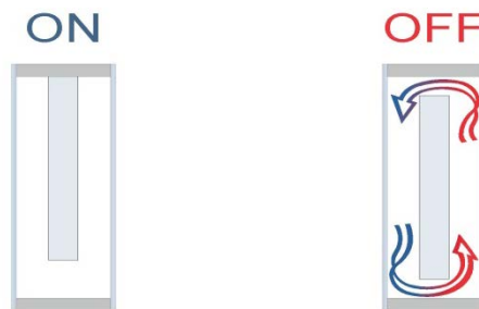
Figure 1 : Élément de façade commutable dans l'état isolant (à gauche) et conducteur (à droite), avec un panneau d'isolation translucide.
