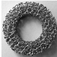
Figure 3 : Anneau de mousse de cuivre
