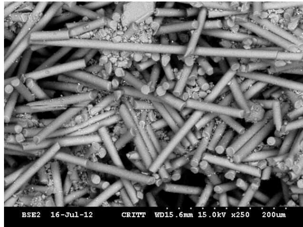
Figure 2 : Imagerie MEB (200 \mu\text{m} ) d'un échantillon en fibres de silice (CREE-Saint Gobain, SilPower data book)
