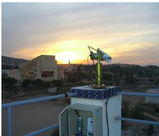
Figure 1: Photomètre solaire CIMEL installé à Oujda.
