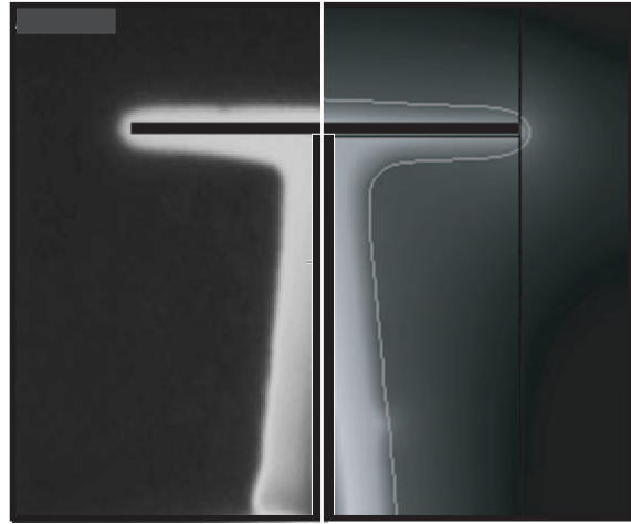
Figure 5 : Comparaison image en thermographie IR et simulation numérique
