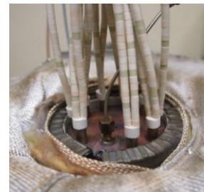
Figure 11 : Moteur avec collier et cartouches chauffantes
