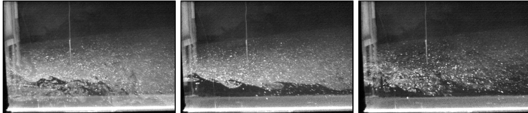
Figure 4 : Tomographie laser sur ZV3; \Delta T = 80^\circ\text{C} , après 1,2 ; 2,4 ; 4,2 sec. (gauche à droite)
