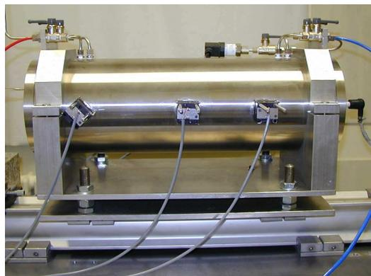
Figure 1 : La chambre de combustion
