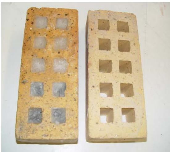
Figure 2 : Photographie d'une brique creuse (à droite) et de la brique remplie de paraffine (à gauche)
