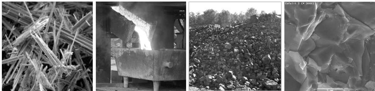
Figure 1 : (a) fibres d'amianté au MEB, (b) coulée du vitrifiat, (c) COFALIT® concassé, (d) COFALIT® au MEB
