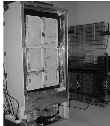
Figure 2: Vue de l'évaporateur avec les compartiments de PCM
