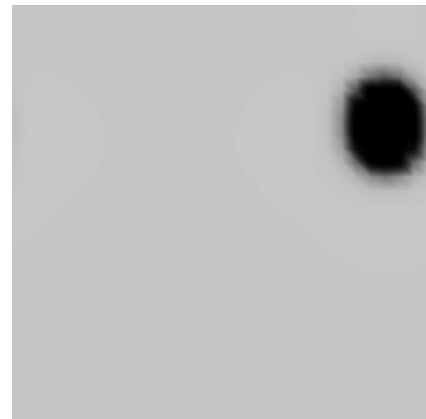
Figure 6 : A l'état final, comme le prévoit la thermodynamique, il reste qu'une seule goutte de liquide et la température dans tout le fluide est imposé par les parois.
