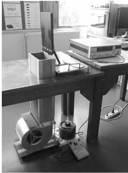
Figure 3. Photographie du dispositif expérimental composé du ventilateur, de l'alternostat, du canal diffuseur, du fil chaud attaché à la plaque et de l'amplificateur synchrone.
