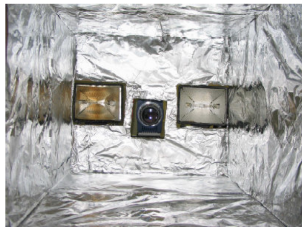
Figure 2 : Vue intérieure du cube recouvert d'aluminium, de la caméra IR et des lampes.
