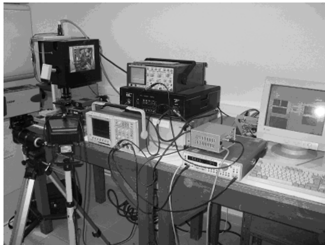
Figure 2: Le dispositif d'analyse photothermique aléatoire face arrière sans contact utilisé
