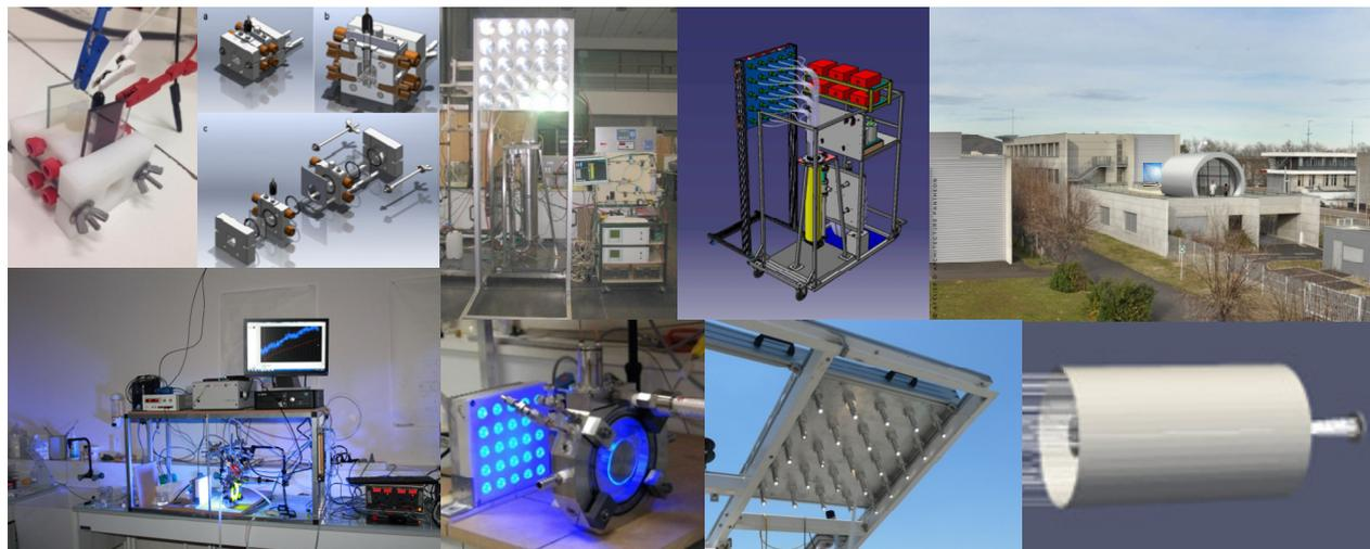
*Exemples de dispositifs d'étude des systèmes photo-réactifs et de dispositifs pilote à haute efficacité développés par l'équipe d'accueil ; en haut à droite, vue d'architecte de la future plateforme d'expérimentation PAVIN solaire du laboratoire.*
