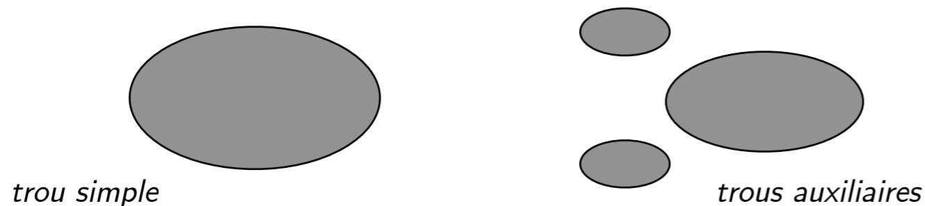
figure 7: Géométrie des trous testés sur le banc d'essai BATH de l'institut P'.
