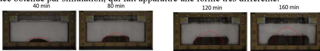
Figure 4 : Visualisations en cours de fusion à  $t=40\text{min}$ ,  $80\text{min}$ ,  $120\text{min}$  et  $160\text{min}$ - chauffage par la paroi horizontale – trait rouge : position du front liquide-solide obtenue par simulation
