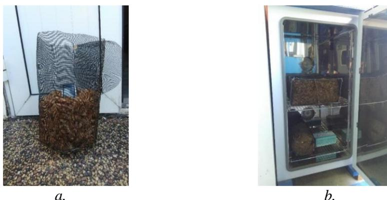
Figure 2 : Dispositif expérimental de l'échantillon testé (ici, copeaux de bois de *Cryptomeria japonica*) placé dans le cylindre (a) puis dans l'étuve (b).
