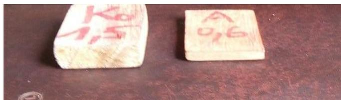
**Figure 1:** Eprouvettes de kosso (Ko) et d'afzélia, (A)
