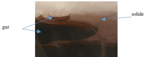
Figure 5 : Photo de l'interface en présence de bulles
