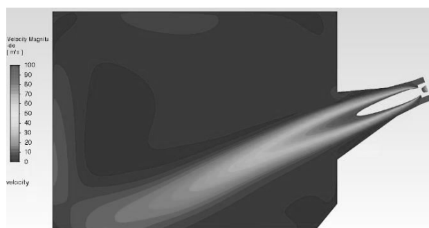
Figure 7 : Champ de vitesse – cas gaz naturel ( 600 \text{ kW}_{\text{PCI}} ).
