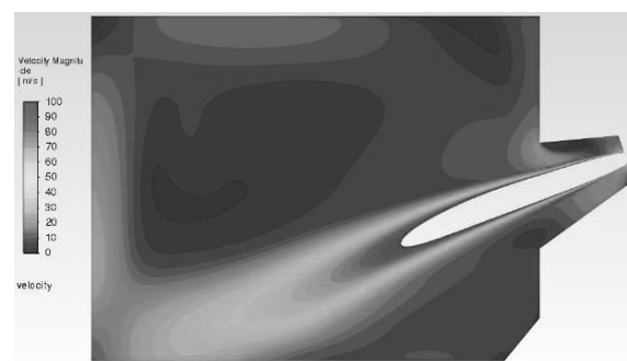
Figure 8 : Champ de vitesse – cas plasma ( 400 \text{ kW}_{\text{net}} , basse enthalpie).
