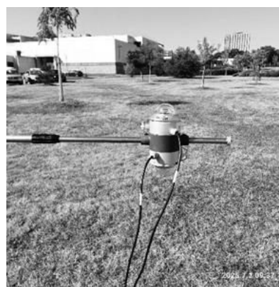
Figure 3b : Détail de la mise en œuvre des deux pyranomètres
