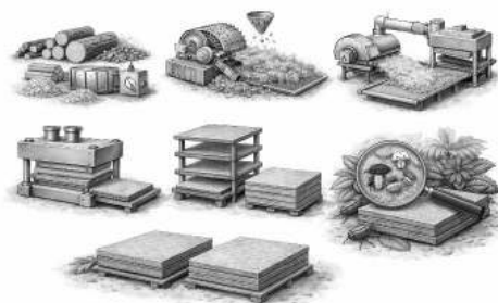
Figure 1 : Schéma illustratif du processus de fabrication des panneaux en fibres de bois guyanais.
