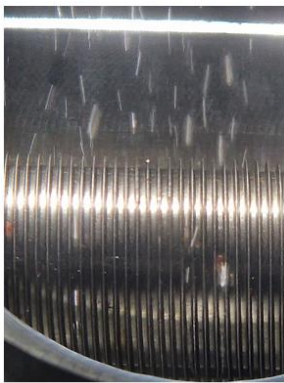
Figure 4-a : Low-Fin pour un \Delta T de 2K
