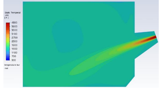
Figure 6 : Champ de température – cas plasma (400 kW net , basse enthalpie).
