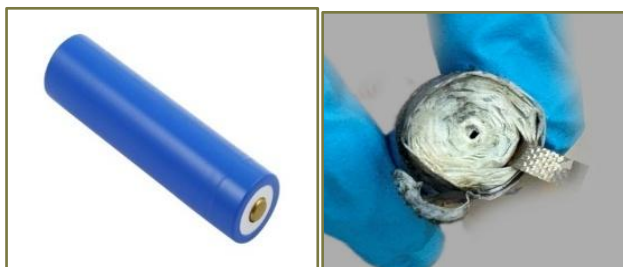
Figure 1 : Cellules de batterie LFP 18650 : vue extérieure et coupe transversale
