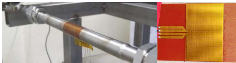
Figure 1: Implantation du dispositif sur une conduite (gauche) zoom sur une sonde (droite)
