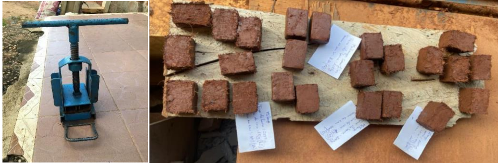
Figure 3 : Echantillons de terre de barre améliorée aux fibres de coco
