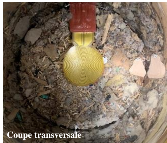
Figure 3 : Positionnement de la sonde entre les deux couches de CSR
