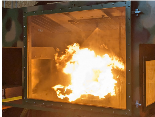
Figure 1 : Essai d'extinction au brouillard d'eau additivée dans le compartiment moteur.
