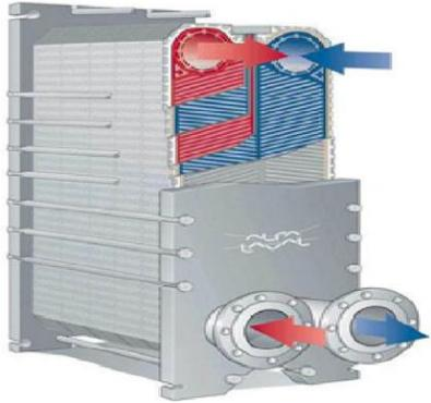
Figure 1.1 Echangeur de chaleur à plaques [2]
