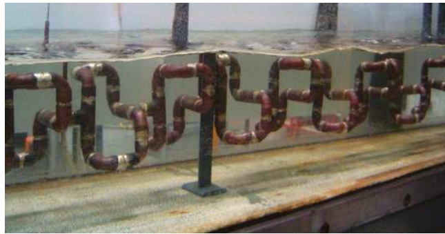
Figure 2 Photographie du mélangeur baignant dans le canal.
