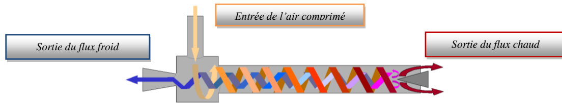
Figure1 : Tube vortex de Ranque-Hilsch
