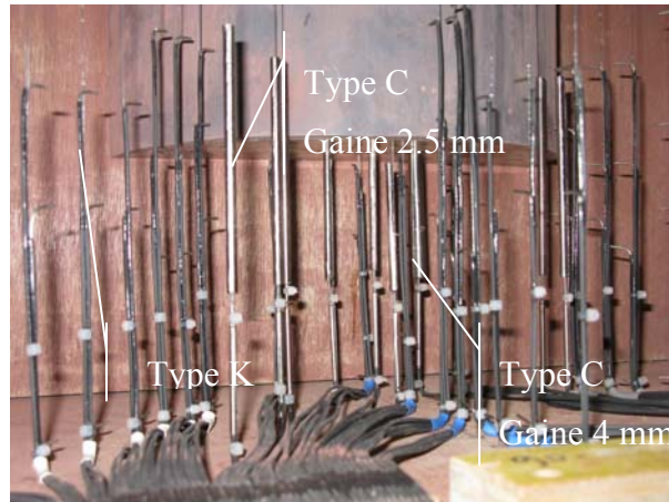
Figure 1 : Thermocouples instrumentant la section d'essai (photographiés avant de couler le béton)
