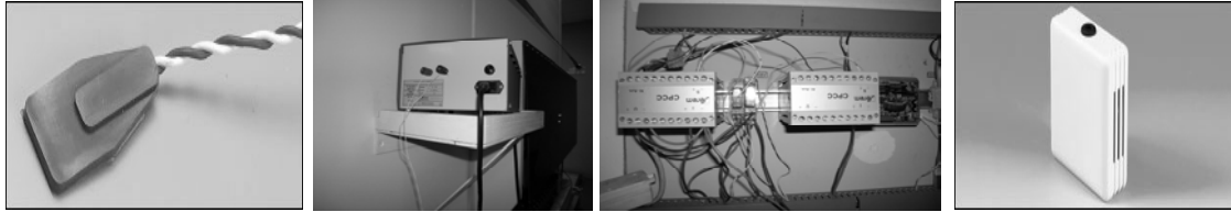
Figure 2 : Capteur de température de surface PT 100 ; Convertisseur de puissance et son câblage ; Capteur de température d'air.
