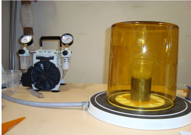
Figure 5 : Evacuation sous vide des bulles d'air avant l'injection
