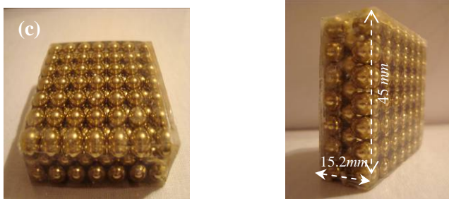
Figure 7: Echantillon ( c ): résine époxy + billes en laiton de 6.35mm de diamètre.
